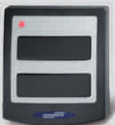
Fjernbetjent indvendig kontakt, signal 111 2 kanaler, 433 MHz, KeeLoq med skiftende kode til styring af 2 porte
